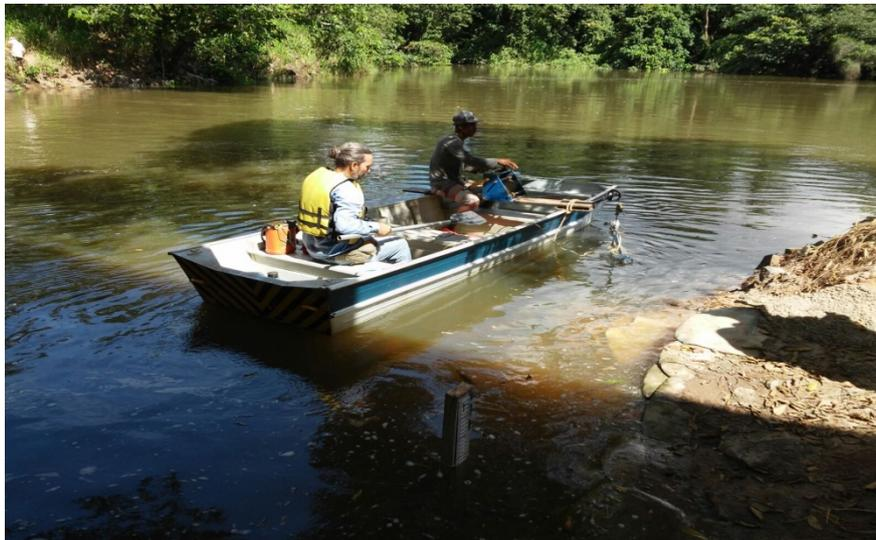
Figura 8: Medições de vazão à jusante do extravasor da Barragem Joanes II
